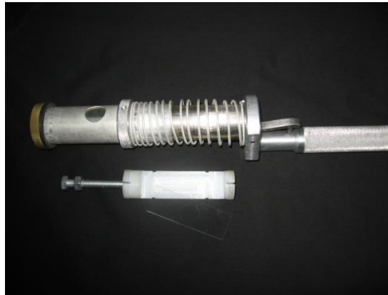
Рис. Зовнішній вигляд пристрою для уловлення крапель з газорідного потоку
