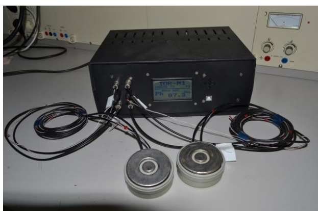
Макетний зразок три частотного вимірювача всіх параметрів повного опору провідникових об'єктів на частотах 20, 100 і 500 кГц.
