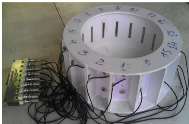
Макетний зразок тривимірної конструкції фізичного фантому для досліджень в імпедансній томографії.
