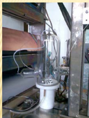
Пристрій для іонного бомбардування у квазізамкненому об'ємі
