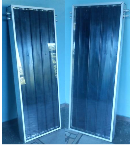
2. Загальний вигляд діючих макетів сонячних колекторів, виготовлених з профільних алюмінієвих теплових труб
