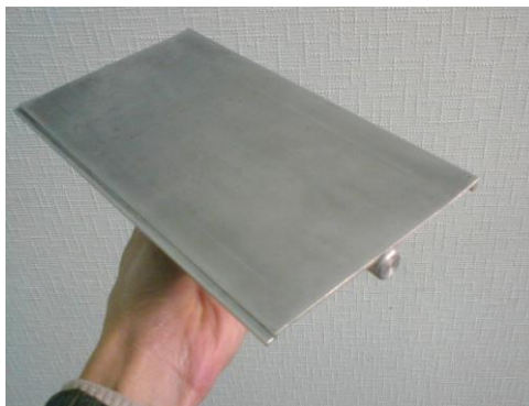
1. Фрагмент теплової труби з алюмінієвого профілю, створеної для сонячних колекторів
