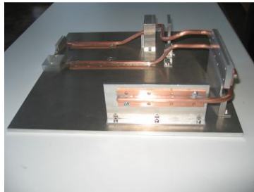
Мініатюрні теплові труби для системи охолодження блока живлення в проекті MASCOT
