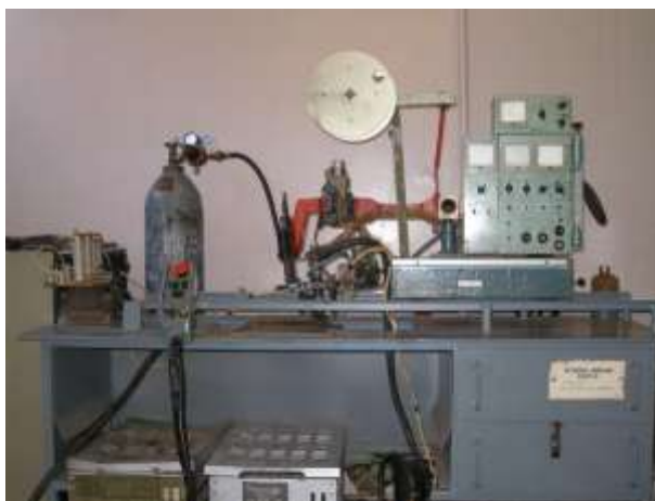
Макет плазмового пристрою для нанесення покриттів із магнітним керуванням процесом формування газопорошкового потоку
