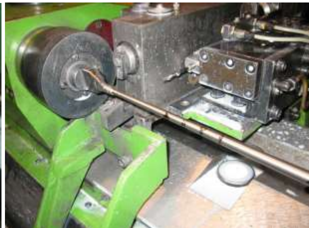
Процес шліфування оправки за програмою, що спроектована САМ-системою
