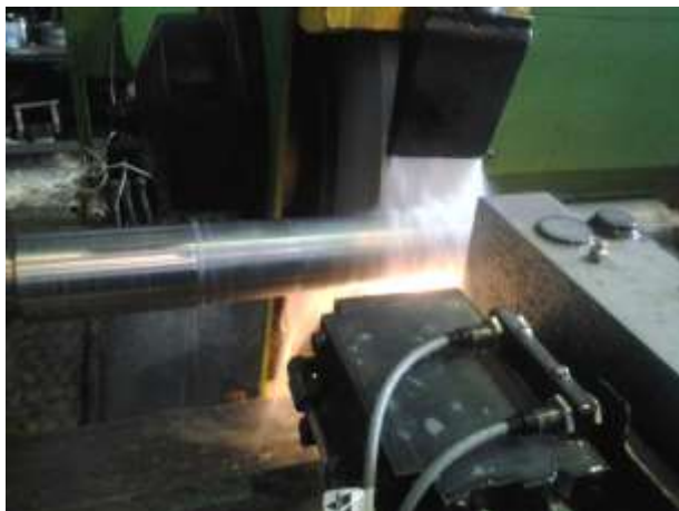
Процес шліфування оправки за програмою, що спроектована САМ-системою
