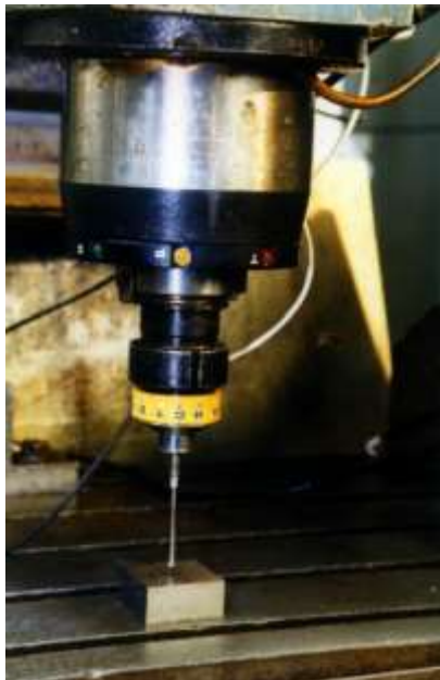
Периферійна вимірювальна головка із інтегрованою плиткою при вимірюванні руйнацій робочої поверхні верстата
