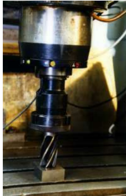
Контрольно-вимірювальний фрезерний інструмент при вимірюванні руйнацій робочої поверхні столу верстата
