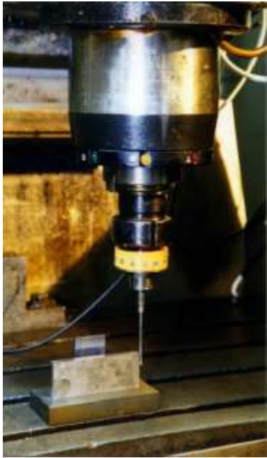
Вимірювання люфта координатних рушіїв верстата за допомогою вимірювальної головки М-17 та плити Йогансона
