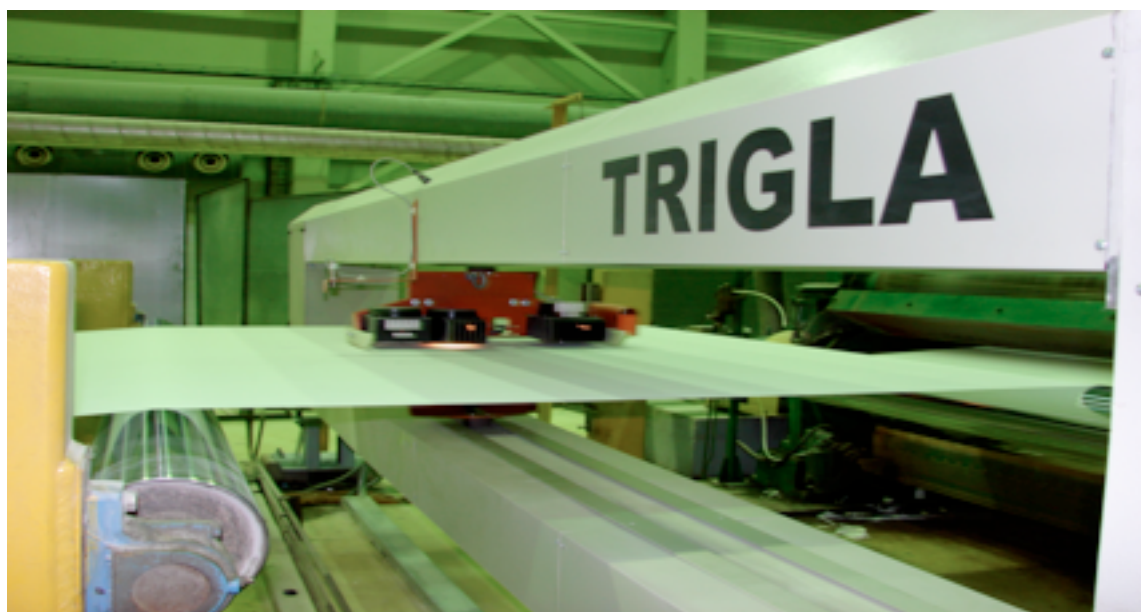
Рисунок 1 - Скануюча система технологічного контролю параметрів рухомого паперового полотна. Над ним і під ним на каретці, що рухається поперек полотна, встановлені датчики вологості, поверхневої густини і ін..
