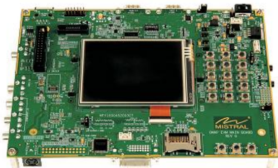
Макет обчислювального та вимірювального каналів системи на основі процесорної платформи ОМАР 35х
