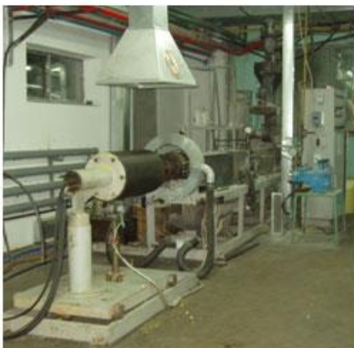
Експериментальна установка для виготовлення спінених термопластів екструзійним методом
