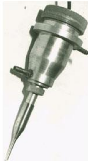
Експериментальний вузол для УЗ-обробки за допомогою концентратора поздовжніх УЗК
