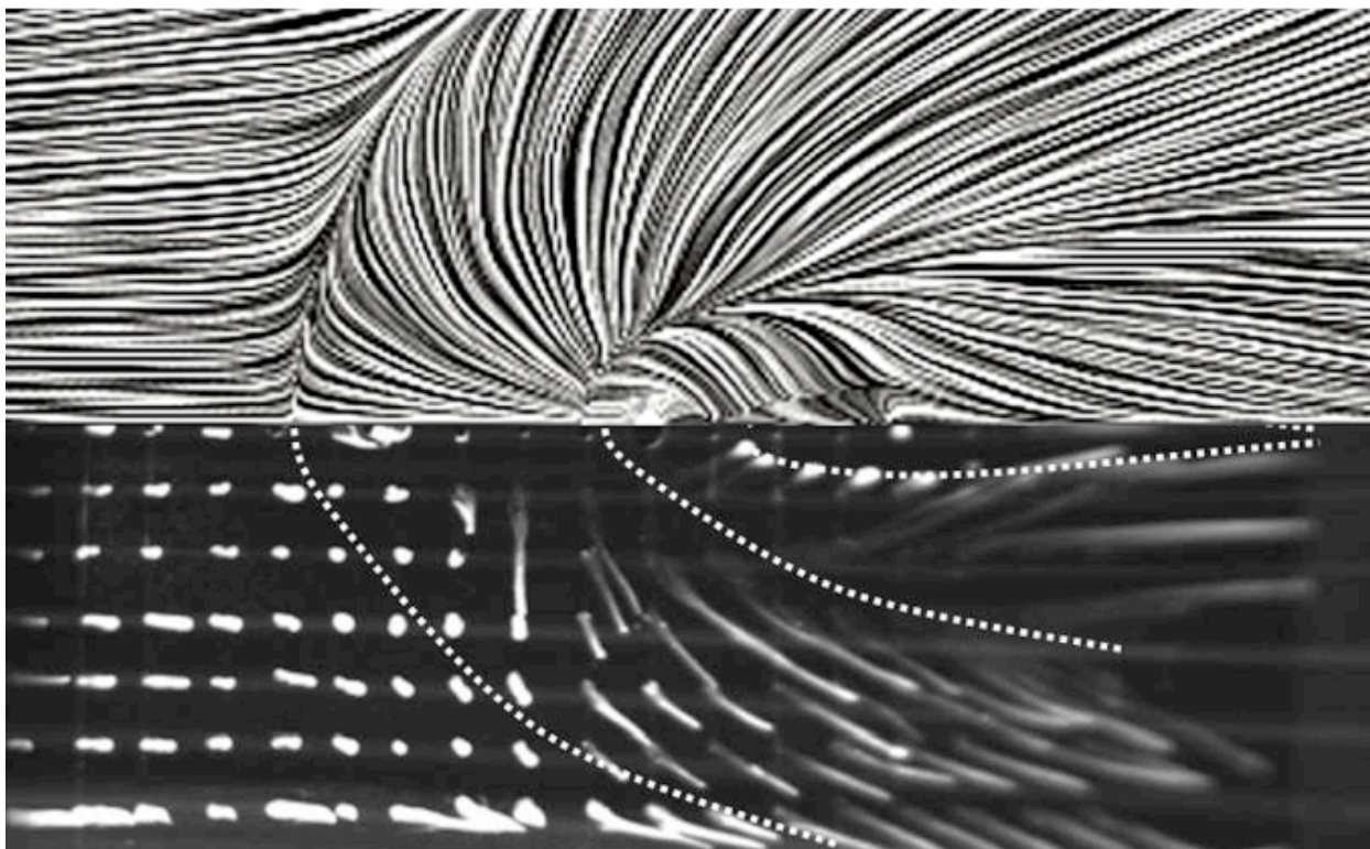
Лінії плівкової течії по твердій стінці в порівнянні з лініями поверхневої течії крапель у експерименті (конфігурація корпус – газовий струмінь)
