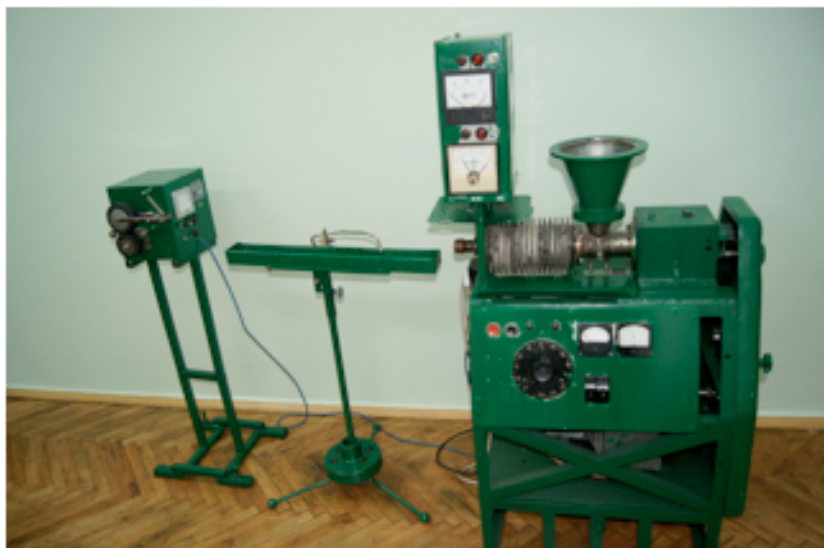
Експериментальна установка для дослідження процесу екструзії з вільним розбуханням екструдату
