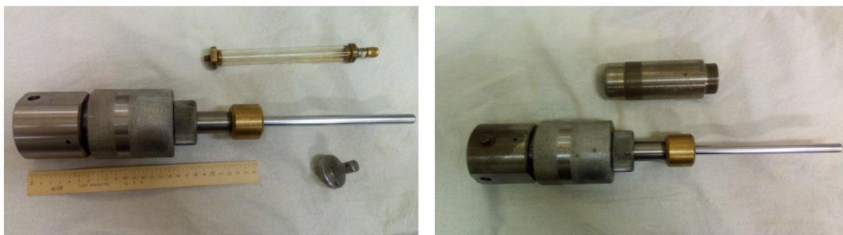
Експериментальний зразок демпфера-дисипатора на базі РК
