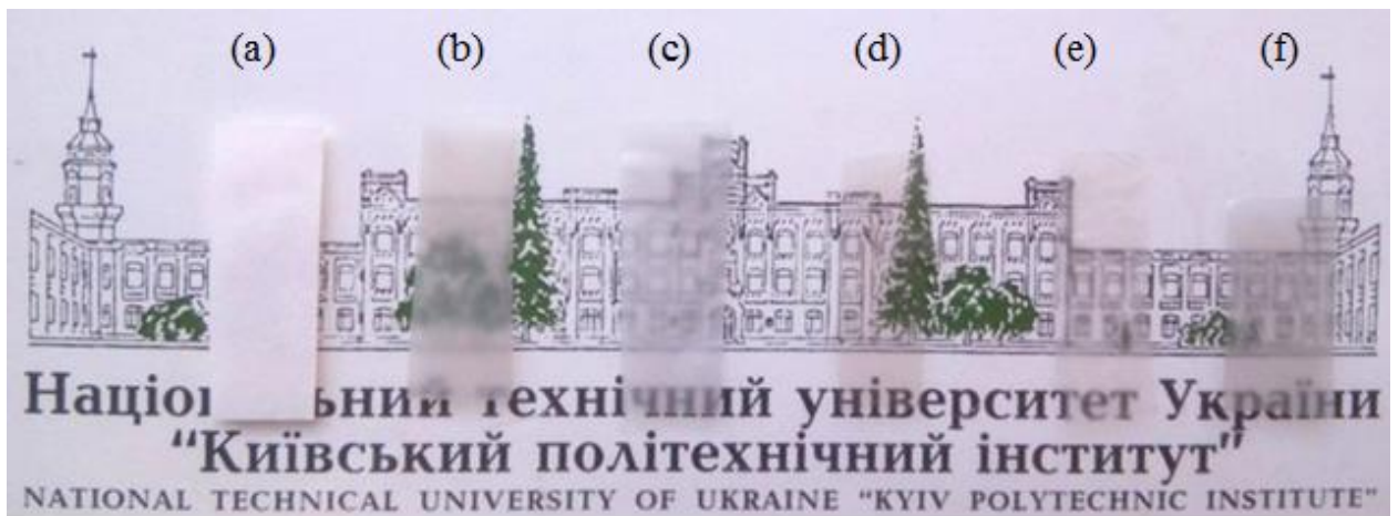
Зразки вихідної целюлози після подрібнення до 92 °ШР (а) і після гідролізу сульфатної кислотою різної концентрації: 18% (б), 30% (с), 43% (р), 50% (е), 64% ( е)
