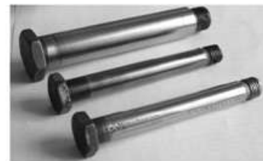
Рис. 2. а – типи головок, б – обладнання для УЗУО металевих виробів, в – ударний інструмент для УЗУО, г – зовнішній вигляд деталей після УЗУО
