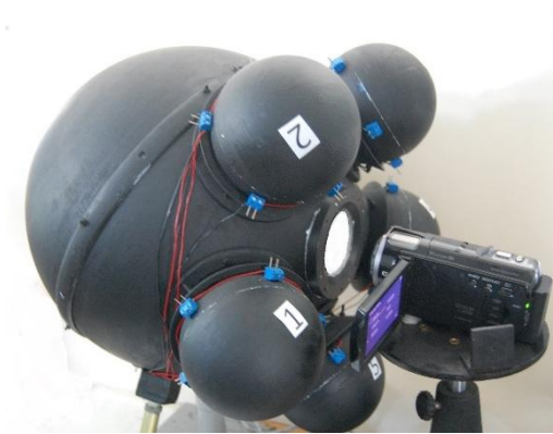
Рис. 1. Розроблений лабораторний макет вимірювання ФПС та зонної характеристики
