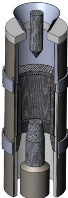
Схема розміщення поясів водяного охолодження термонапружених зон обичайки електрокальцинатора для графітування нафтового коксу
