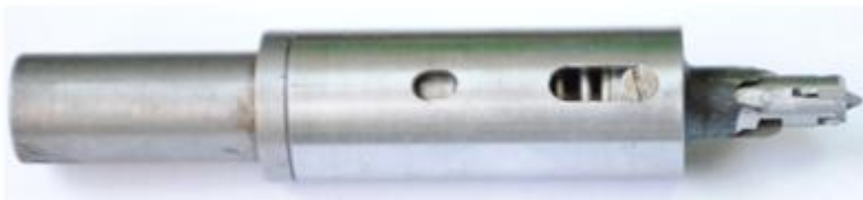
Експериментальний зразок інструментального пристрою для свердління отворів у композиційних матеріалах
