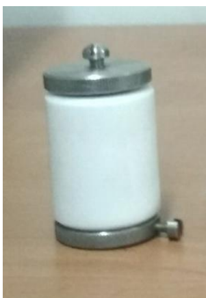
Макет ЛДС з катодом на основі суміші \text{SiO}_2+\text{TiO}_2 після УВО
