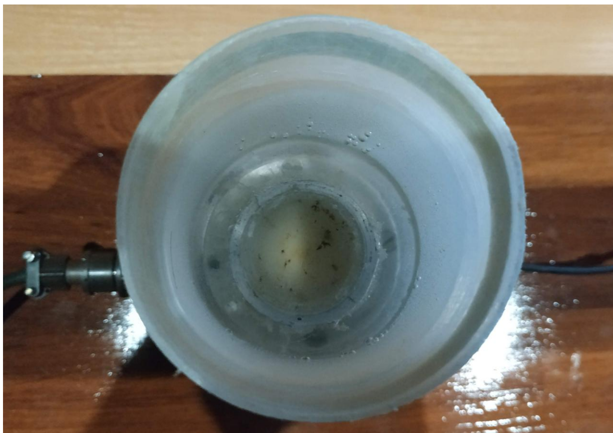
П'єзоелектричний перетворювач з фокусувальною акустичною лінзою
