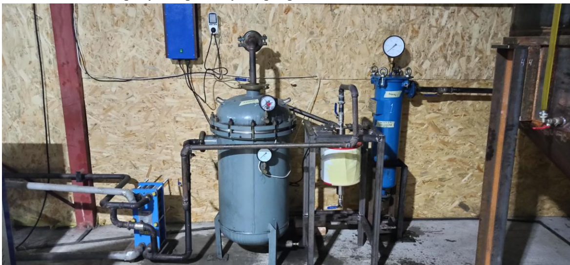
Впровадження ультразвукового кавітаційного реактору для знезараження рідин з видаленням продуктів розпаду мікроорганізмів
