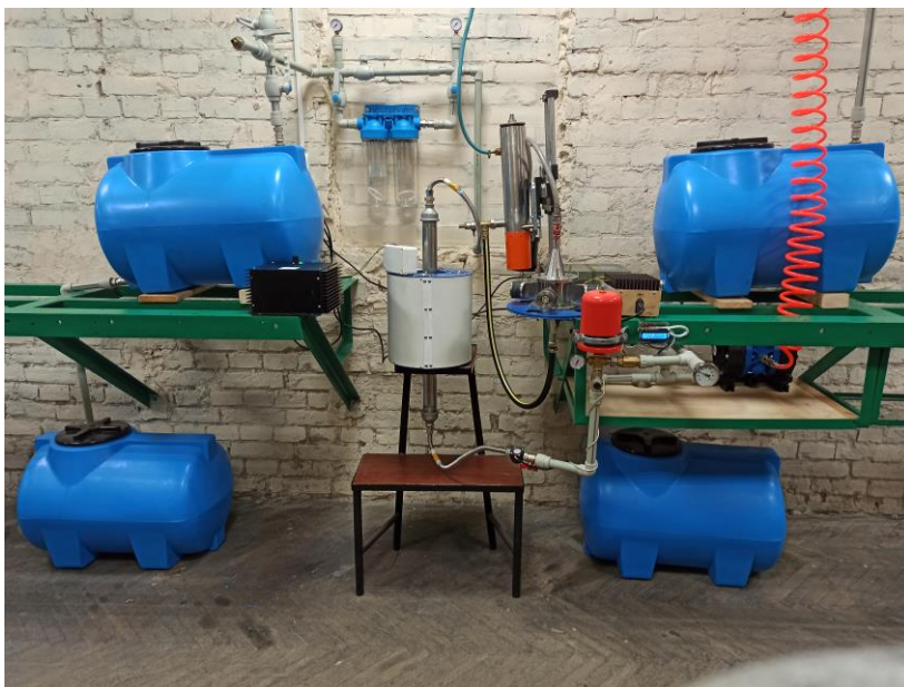
Система для випробування ультразвукового кавітаційного реактору для знезараження рідин з видаленням продуктів розпаду мікроорганізмів
