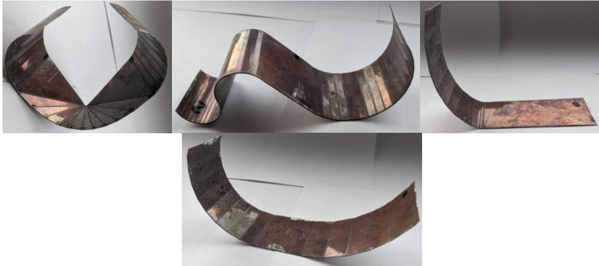
Рис. 5. Зразки сформовані за допомогою лазерного формоутворення.
