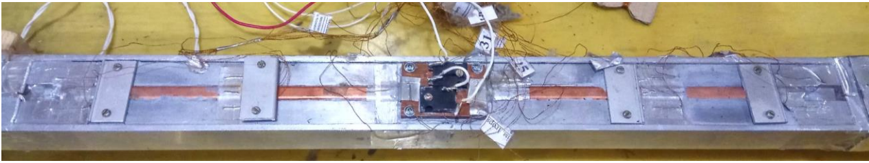
Експериментальний зразок конвективного теплообмінника з вбудованою тепловою трубою (1/4 частина корпусу ПМ)
