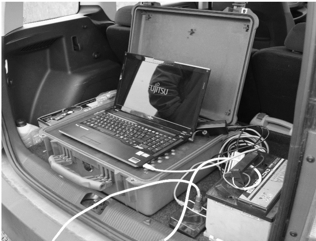
Макет посту збору, живлення та обробки інформації від експериментального зразка сейсмоакустичного розвідувального комплексу.
