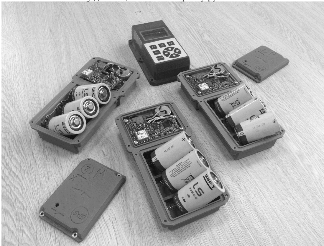
Зовнішній вигляд експериментального зразка сейсмоакустичного розвідувального комплексу дистанційного моніторингу рухомих об'єктів
