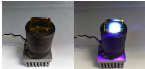
Рис. 1. Вигляд зразка поруватого SiO 2 :C з розміром пор 7 нм при освітленні лампою розжарювання (зліва) та під світлодіодним освітленням 409 нм (зправа).
