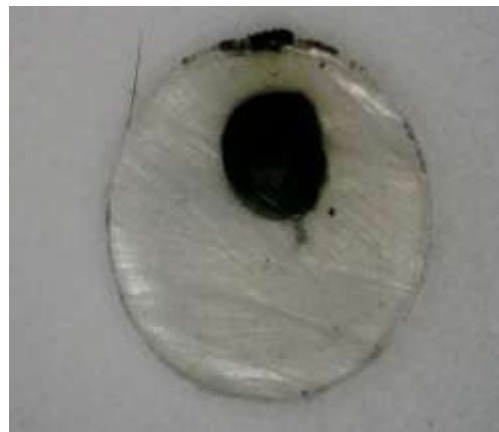
Отримані зразки полімерної стренги з інжектованою порцією суміші полімеру з вуглецевим наповнювачем
