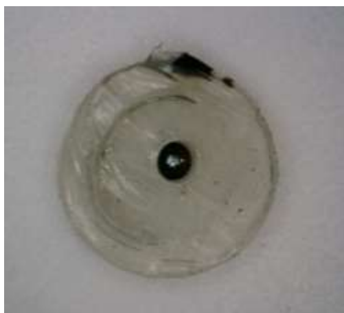
Отримані зразки полімерної стренги з інжектованими макетами, які імітують інтелектуальний датчик
