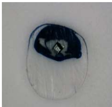
Отримані зразки полімерної стренги з інжектованими макетами, які імітують інтелектуальний датчик
