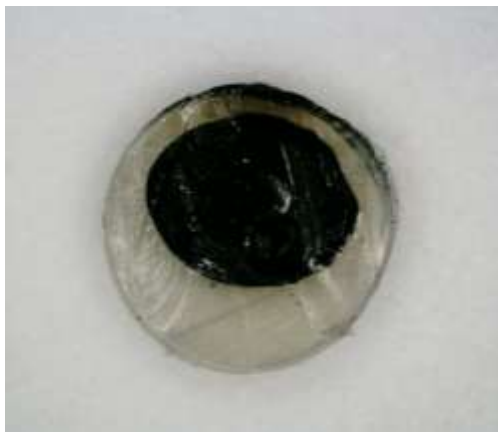
Отримані зразки полімерної стренги з інжектованою порцією суміші полімеру з вуглецевим наповнювачем
