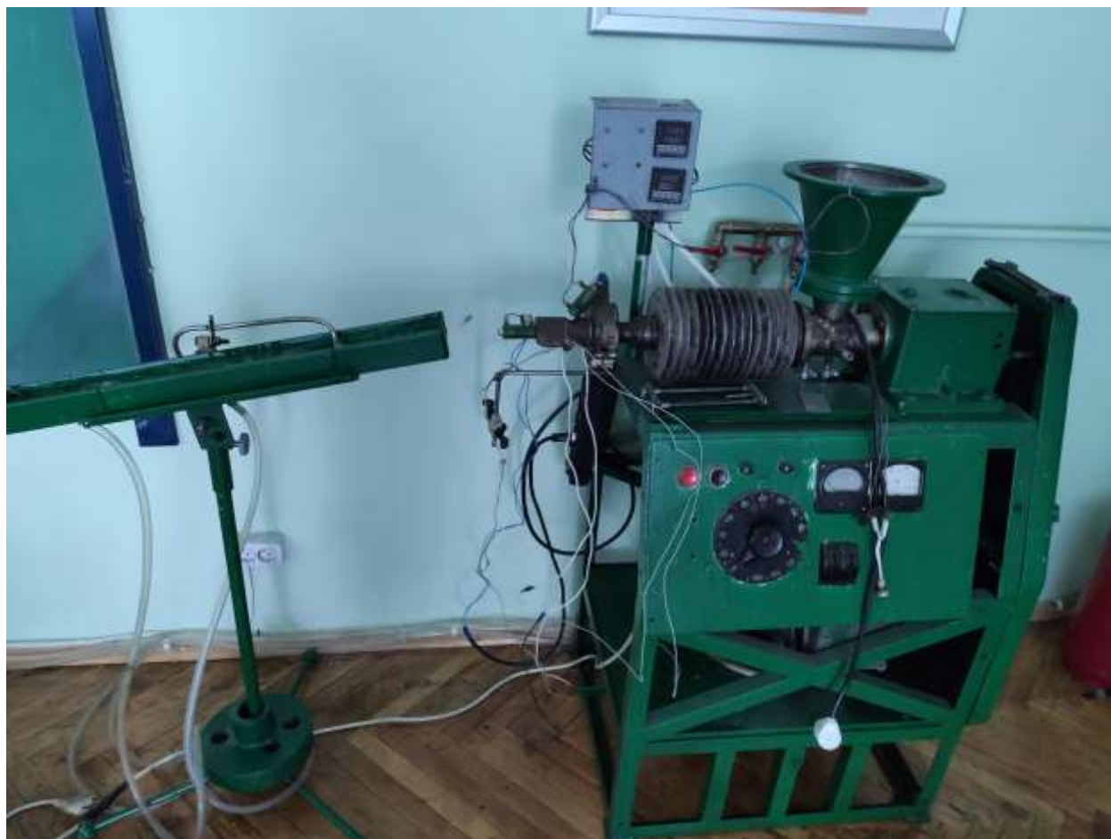
Експериментальна установка для дослідження інжекції інтелектуальних датчиків в процесі екструзії
