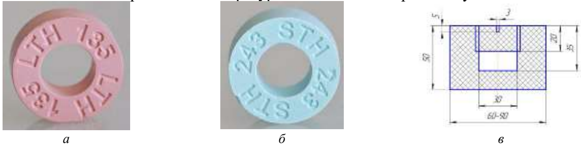
Термометричні кільця контролю температури марок LTH (а) і STH (б) та конструкція графітового стакану (в) для їх розміщення
