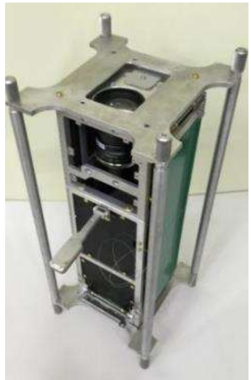
Рисунок 4 – НС в контейнері для транспортування - а) з СБ в зібраному вигляді, б) загальний вигляд POLYITAN-3-PUT
