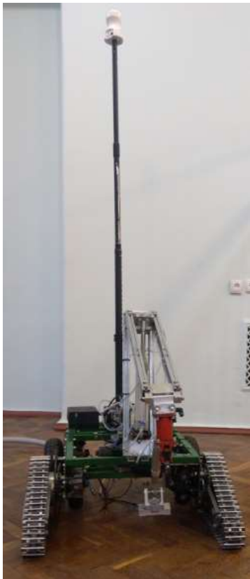
Мобільний робот з оптичною системою на основі телескопічної штанги
