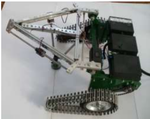
Гусеничний модуль шасі мобільного робота з маніпулятором на основі механізмів з паралельними кінематичними структурами.
