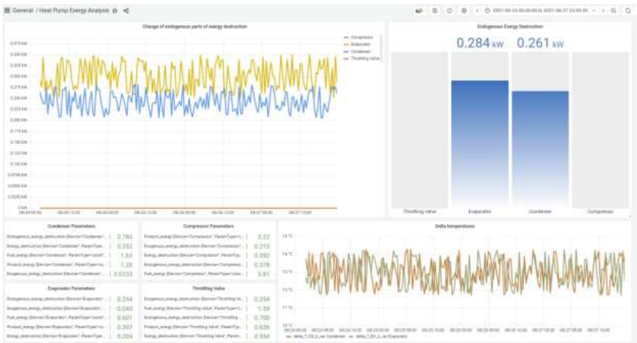
Рис. 8. Приклад реалізації технології цифрового двійника теплонасосної установки для діагностування методами ексергетичного аналізу наявності та стану дефектів у її компонентах
