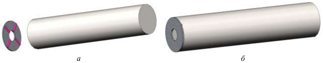
a – на електроконтактну прокладку нанесено чотири смуги клею; б – електроконтактну прокладку прикlesно й відцентровано на торці електродної заготовки Етапи монтажу електроконтактної прокладки \varnothing 220/\varnothing 630 мм товщиною 20 мм на торцевій поверхні електродної заготовки \varnothing 630 \times 2815 мм
