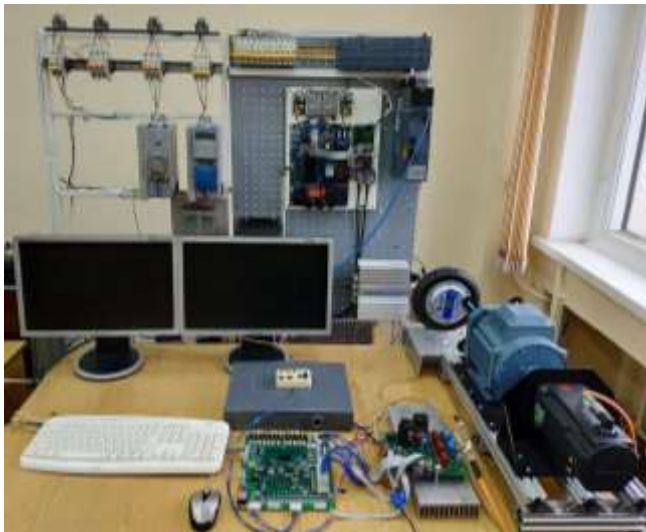
Лабораторний стенд з силовим перетворювачем з транзисторами на основі силікон-карбїду
