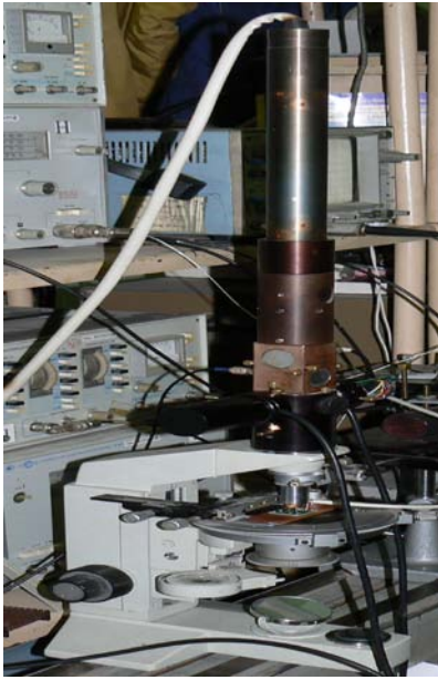
Диференційно-фазовий скануючий лазерний мікроскоп для дослідження перерізів чутливих елементів
