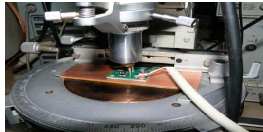
Плата з досліджуваним сенсором ГЧ випромінювання (вид зверху та під час роботи)
