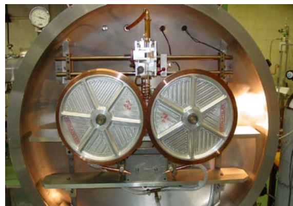
Установка для формування гетероструктур сенсорних чутливих елементів
