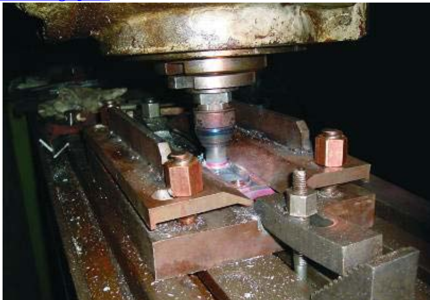
Робоча зона експериментальної установки для формування покриттів методом тертя з перемішуванням та для обробки поверхні методом тертя з перемішуванням
