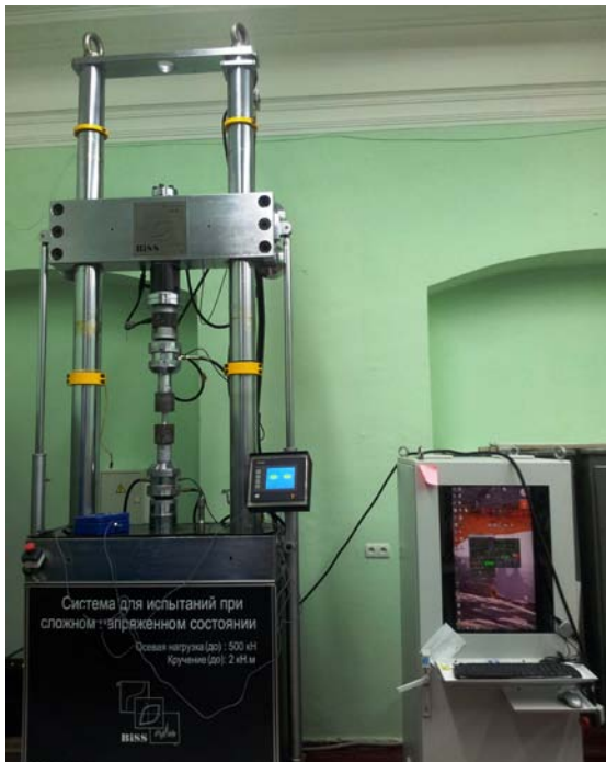
Автоматизована експериментальна установка на базі випробувальної машини Vi-02-112
