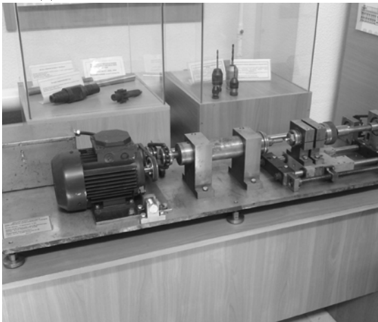
Діючий макет верстата для обробки полігональних отворів, побудований на модульному принципі
