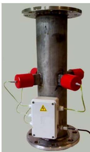
Ультразвукова проточна кавітаційна камера для гідролізу-екстракції пектину з рослинної сировини
