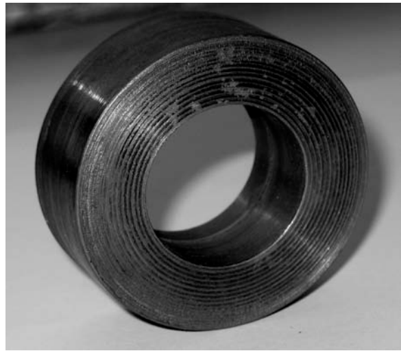
Рис. Загальний вигляд натурних втулок різних типорозмірів з матеріалів на основі шліфувальних відходів сталей: а - P6M5+5%CaF 2 та б - P6M5Ф3+5%CaF 2 .
